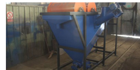
Ванна флотации «ПроСорт ВФ-1» для мойки ПЭТ
