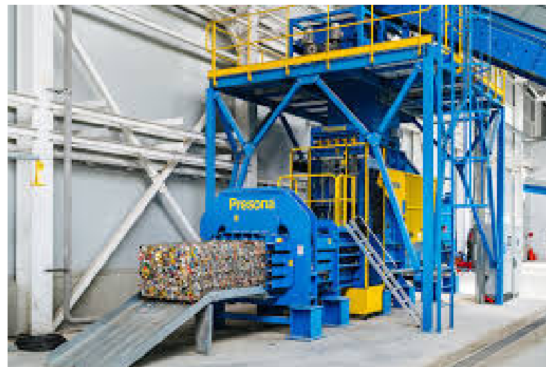
Автоматический горизонтальный пресс для ТКО локализация автоматических прессов Presona
