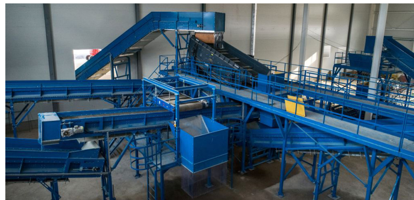
Предназначены для транспортировки ТКО, вторсырья, «хвостов», мелкой фракции и сортировки отходов
