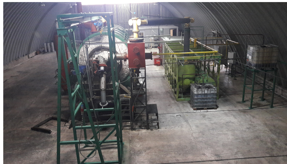
Модульно-мобильная установка по утилизации углеводородсодержащих отходов методом пиролиза «Реактор-2»
